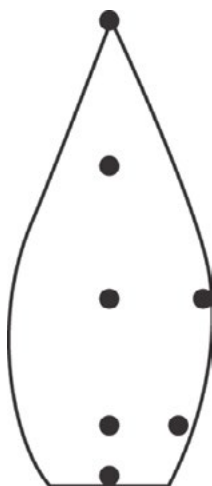
Рис. 1. Точки измерения температуры пламени
